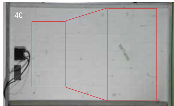
图4C 安装4年后在聚酯背板出现裂纹（西班牙）
