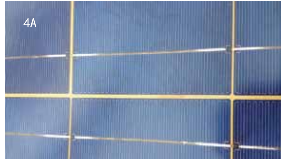
图4A 安装5年后发生焊带腐蚀以及PVDF背板内层黄变案例（西班牙）
