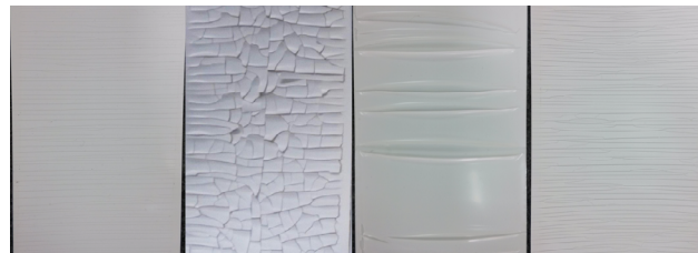
图十：四种典型耐紫外耐水解HPET聚酯背板内层在1000小时耐候性测试后严重开裂(试验条件：氙灯，120W/m 2 @300-400nm, 95°C BHT, 50%RH, 紫外照射在背板空气面)
