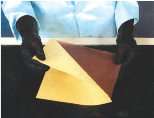
6. 把此后各层直接放在第一层上，对齐边缘。确保纤维方向正确。如果预浸料不能相互粘附，添加胶膜。
