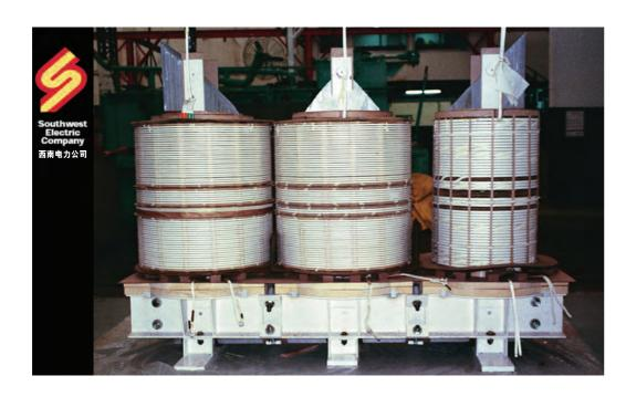
移动变压器经过清彻底的检修和翻新,其性能达到美国国家标准学会/电气与电子工程师协会的最高标准。例如,功率控制最初是由绕在主变压器上的一些独立线圈提供的。经西南电力公司的工程师重新设计后,功率控制由安装并连至主变压器箱外的个单独的功率控制变压器做(CPT)提供。现在如果出现故障,损害将降至最低,并且维修费用也大大降低。
