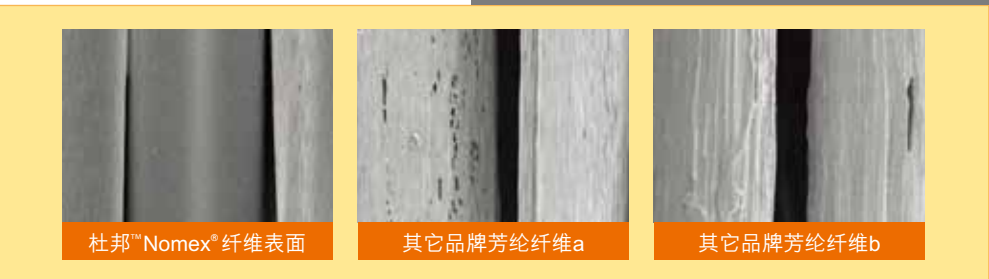
图7：纤维表面电子显微镜照片
